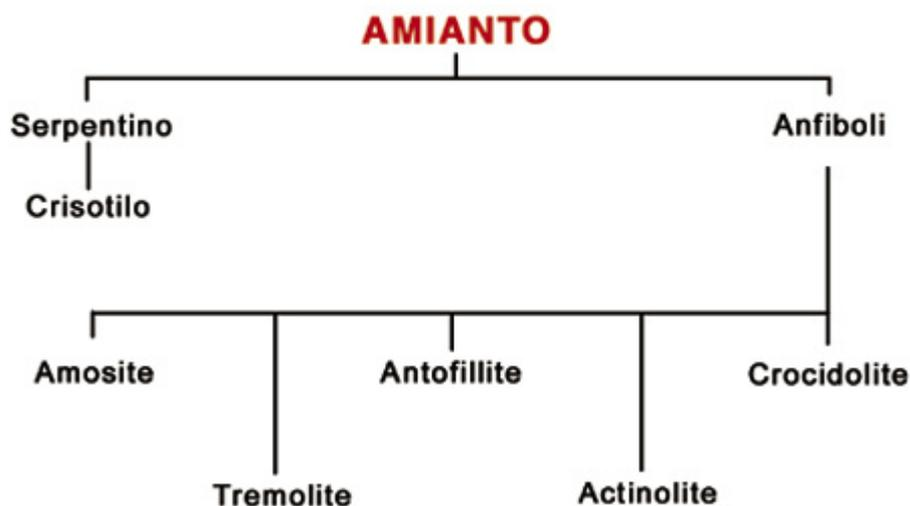
Il crisotilo o serpentino (**amianto bianco**), cosiddetto per la struttura spiraliforme delle fibre viste al microscopio, rappresenta da solo oltre il 90% del materiale estratto ed utilizzato.
